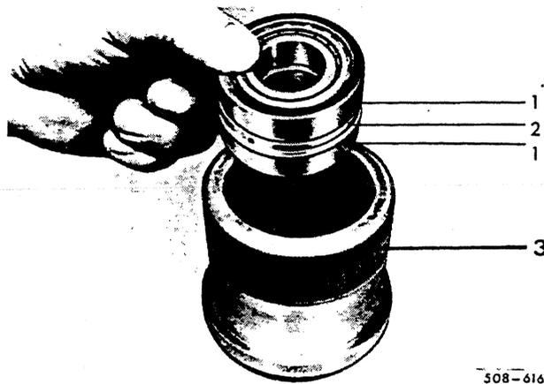
Loger les roulements à rouleaux coniques (1) avec bague d'écartement (2) intercalée dans la douille de l'outil de montage (3) 460 589 00 14 00 NSA 787-0151.
